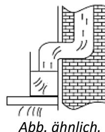
**Horizontal:** Der Abluftschlauch wird zu einer Auslassöffnung mit Gitter\* in der Hauswand geführt.
