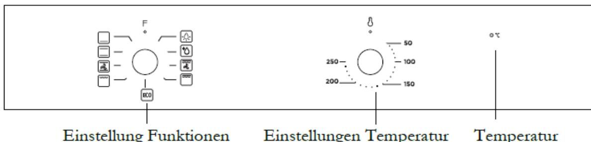
1. Drehen Sie zum Einstellen einer Funktion den Schalter zum gewünschten Symbol.
