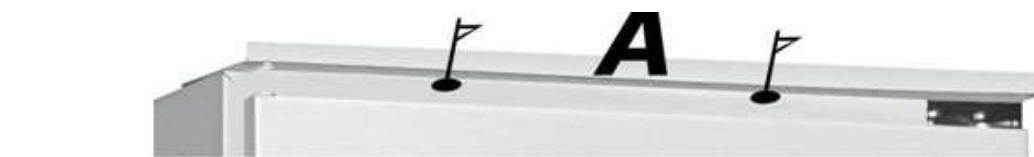
Des points de fixation pour fixer l'appareil avec les éléments A+B déjà montés complètement et les vis à bois inclus pour la niche intégrée.
