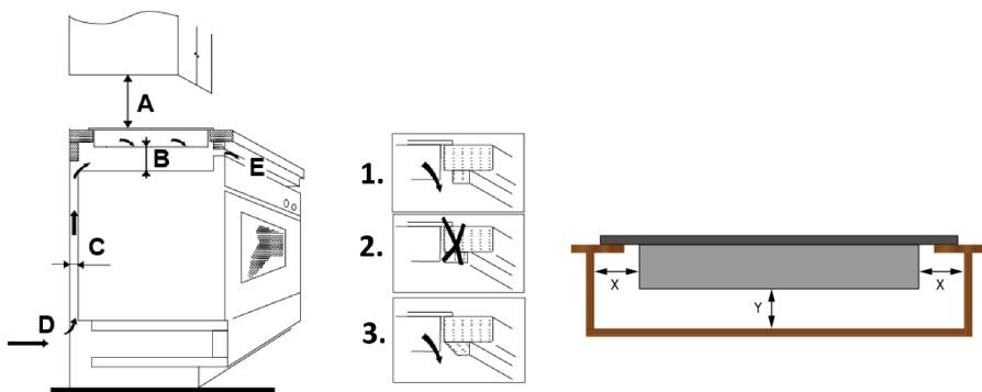
**D = BELÜFTUNGSSCHLITZ / E = LUFTAUSLASS**
