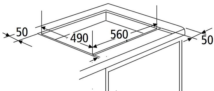
**i** Alle Abmessungen sind in **Millimetern** angegeben.
