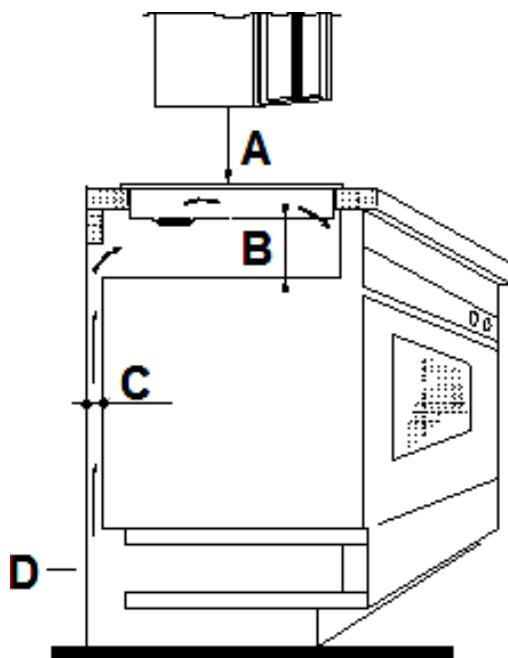
**C = BELÜFTUNGSSCHLITZ**
