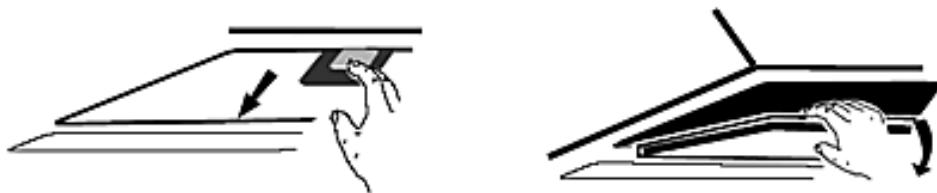
2. Der KOHLEFILTER wird auf dem Motor befestigt.
