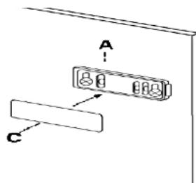
8. Öffnen Sie nun die Gerätetür und die Schranktür um 90°. Setzen Sie das kleine Quadrat B in die Führung A ein. Drücken Sie Geräte- und Schranktür zusammen und kennzeichnen Sie die Löcher wie in der Abbildung angegeben. Entfernen Sie die Quadrate und bohren Sie die Löcher mit einem Durchmesser von 2 mm in einem Abstand von 8 mm von der Außenkante der Schranktür. Setzen Sie das kleine Quadrat B wieder in die Führung A ein und befestigen Sie es mit den gelieferten Schrauben.
