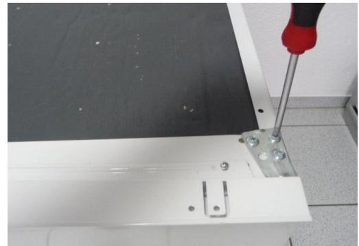
2. Bewegen Sie die obere Tür oben vorsichtig ein wenig vom Gerät weg. Die Tür löst sich nun aus dem oberen Scharnier. Nehmen Sie die Tür aus dem mittleren Scharnier heraus und stellen Sie sie an einer sicheren Stelle ab.
