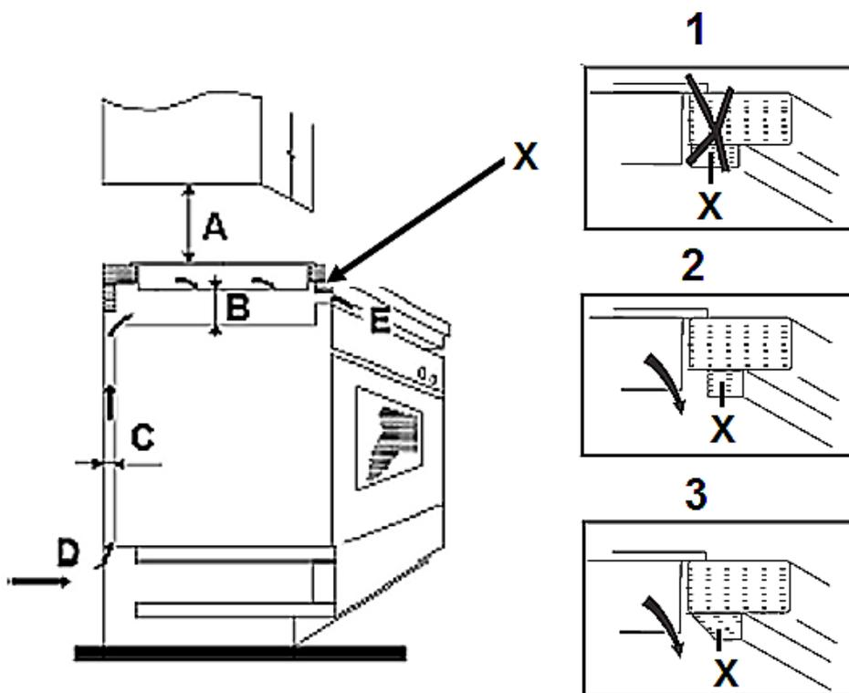
**C = BELÜFTUNGSSCHLITZ**
