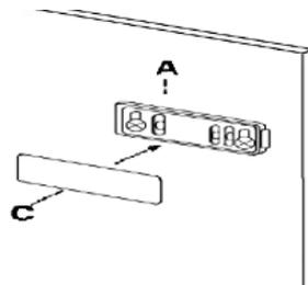
8. Öffnen Sie nun die Gerätetür und die Schranktür um 90°. Setzen Sie das kleine Quadrat B in die Führung A ein. Drücken Sie Geräte- und Schranktür zusammen und kennzeichnen Sie die Löcher wie in der Abbildung angegeben. Entfernen Sie die Quadrate und bohren Sie die Löcher mit einem Durchmesser von 2 mm in einem Abstand von 8 mm von der Außenkante der Schranktür. Setzen Sie das kleine Quadrat B wieder in die Führung A ein und befestigen Sie es mit den gelieferten Schrauben.
