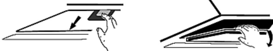
2. Der KOHLEFILTER wird auf dem Motor befestigt.
