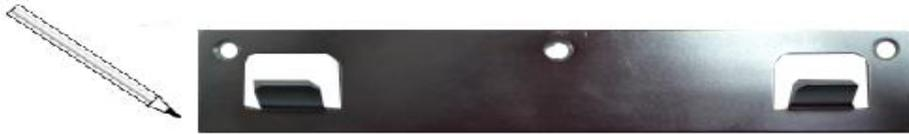
4. Bohren Sie nun die Löcher und befestigen Sie die Aufhängevorrichtung mit den Dübeln und Schrauben.
