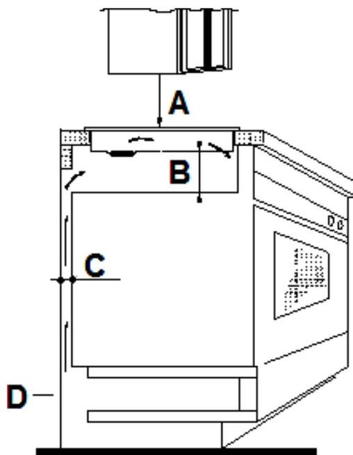
C = BELÜFTUNGSSCHLITZ
