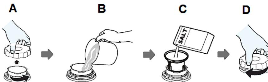
**i** Eventuell müssen Sie nach dem Befüllen mit Wasserenthärter, noch Wasser bis zum max. Limit des Behälters nachfüllen.
