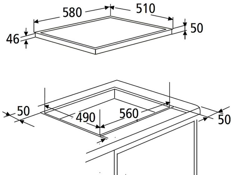
**i** Alle Abmessungen sind in **Millimetern** angegeben.
