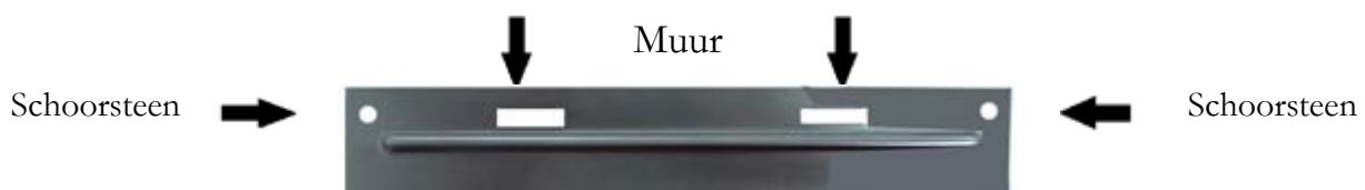
7. Plaats de boven-en onderkant van de schoorsteen op de kap en bevestig de onderkant daaraan (kijk naar de tekening verbinden schoorsteen kap).
