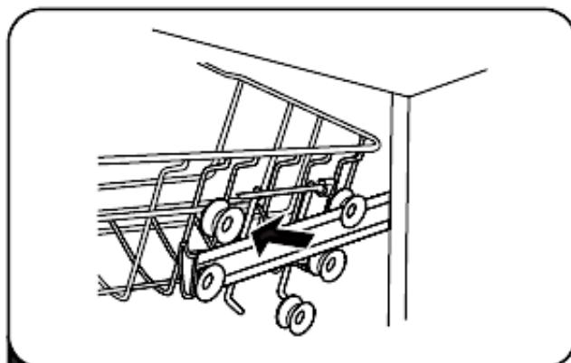
4. Setzen Sie den Geschirrkorb (A) wieder ein und positionieren Sie dabei die Führungsschienen (B) zwischen den mittleren (D) und den unteren Radsätzen (E / s. Abb. unten).
