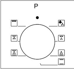
**Programmknopf:** Dient der Festlegung der gewünschten Heizelemente, mit denen die Lebensmittel im Ofen gegart werden sollen. Nachstehend werden die Programmtypen und ihre Funktionen erläutert. Möglicherweise bietet nicht jedes Modell alle Heizelemente und damit auch nicht alle Programmtypen.
