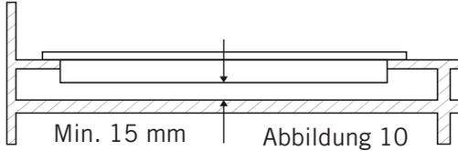
6. Bei Montage des Kochfeldes auf einem Schrank sollte zur Trennung von Schrank und Kochfeld eine Platte montiert werden. Beachten Sie dazu die obige Abbildung. Wenn es über einem Einbauofen montiert wird, ist dies nicht erforderlich.
