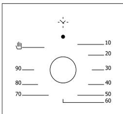
**Mechanischer-Timer-Knopf \*:** Dient der Einstellung der Zeit für die im Ofen zuzubereitenden Lebensmittel. Nach Ablauf der eingestellten Zeit werden die Heizelemente ausgeschaltet und es ertönt ein Signal. Garzeiten entnehmen Sie bitte der Zubereitungstabelle.
