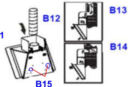
4. Die Haube an der Halterung **B3** aufhängen und Haube durch die 2 Löcher in der Rückwand **B15** festschrauben, damit die Haube nicht versehentlich aushängen kann.
