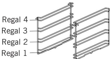
Es ist wichtig, den Drahtgrill richtig in den Backofen zu stellen. Vermeiden Sie, dass das Gitter die Rückwand des Backofens berührt. Regalpositionen sind in der nächsten Abbildung dargestellt. Sie können ein tiefes Fach oder ein Standardfach in die unteren und oberen Gitterregale legen.
