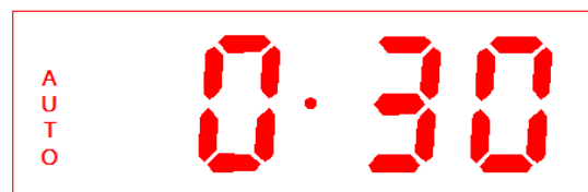
Abb. 17: Gardauer abgelaufen (alle Symbole blinken)
