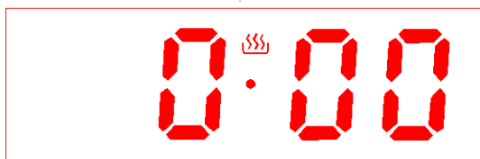
Abb. 6: Uhreinstellmodus (zweites Symbol blinkt)
