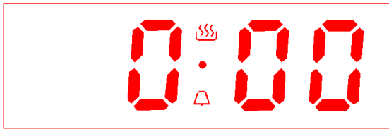
Abb. 11: Alarmsignal eingestellt (Alarmsymbol leuchtet)
