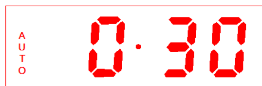
Abb. 17: Gardauer abgelaufen (alle Symbole blinken)
