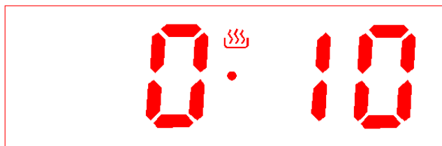
Abb. 13: Ausschalten des Alarms (nach Ablauf der Alarmzeit)
