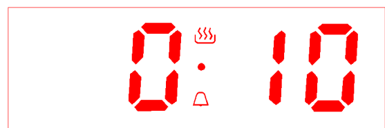
Abb. 10: Alarmsignal eingestellt (Alarmsymbol blinkt)
