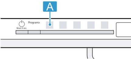
Wenn die LED A nicht leuchtet, ist die drahtlose Netzwerkverbindung ausgeschaltet. Wenn die LED A leuchtet, ist die drahtlose Netzwerkverbindung eingeschaltet.
