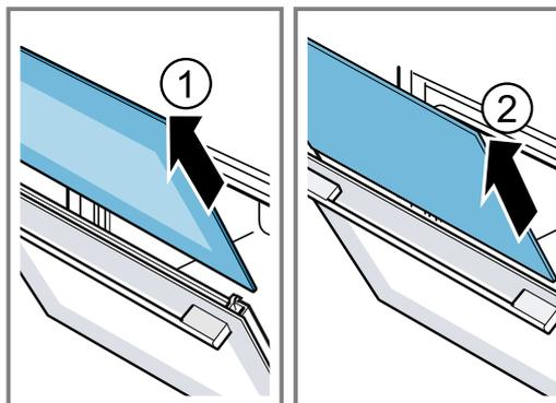
8. Bei Bedarf können Sie die Kondensatleiste zum Reinigen herausnehmen.
