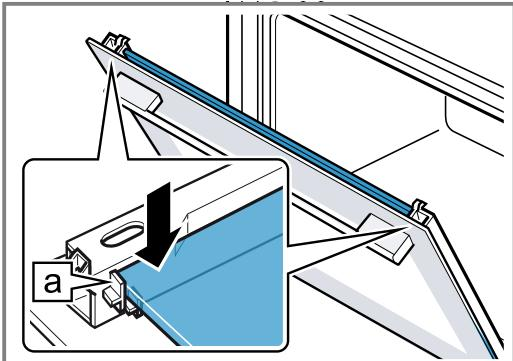
5. Die Gerätetür öffnen und Türdichtung einhängen.
