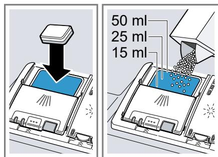
Wenn Sie Tabs verwenden, genügt eine Tablette. Tabs quer einlegen. Wenn Sie Pulverreiniger oder Flüssigreiniger verwenden, beachten Sie die Dosierungshinweise des Herstellers und die Dosierungsteilung der Reinigerkammer. Bei normaler Verschmutzung genügen 20 ml – 25 ml Reiniger. Bei wenig verschmutztem Geschirr genügt eine etwas geringere als die angegebene Reinermenge.
