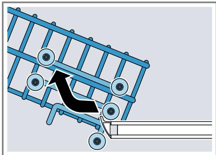
3. Den Geschirrkorb auf den oberen Rollen (Stufe 3) oder unteren Rollen (Stufe 1) einhängen.
