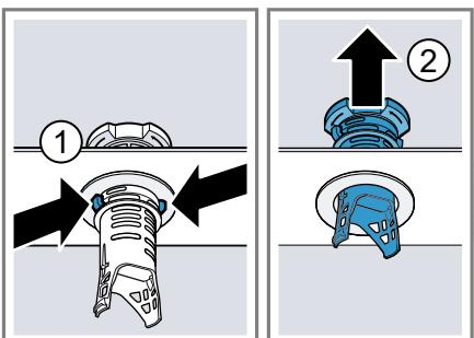
5. Unter fließendem Wasser die Siebelemente reinigen.
