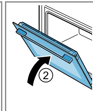
4. Die Türabdeckung links und rechts von außen drücken ①, bis sie ausrastet.
