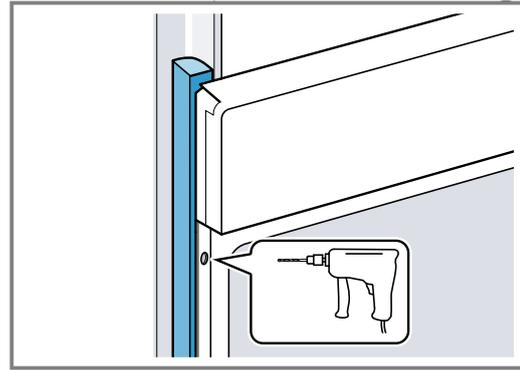
4. Das Gerät mit adäquater Schraube befestigen.
