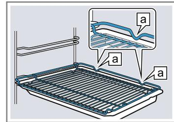
Rost Den Rost mit der offenen Seite zur Gerätetür und der Krümmung ~ nach unten einschieben.
