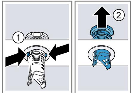
5. Unter fließendem Wasser die Siebelemente reinigen.
