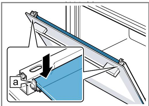
5. Die Gerätetür öffnen und Türdichtung einhängen.
