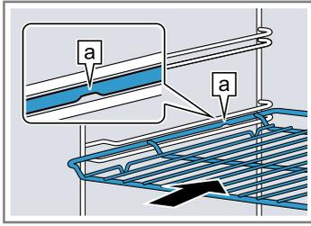
**Blech** z. B. Universalpfanne oder Backblech Das Blech mit der Abschrägung  $\square$  zur Gerätetür einschieben.
