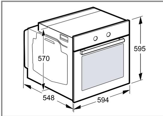
**19.3 Einbau unter einer Arbeitsplatte**
