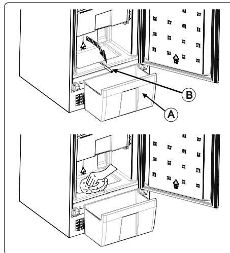
3. Wasser, das dennoch auf den Geräteboden gelangt, kann mit einem Schwamm aufgewischt werden.
