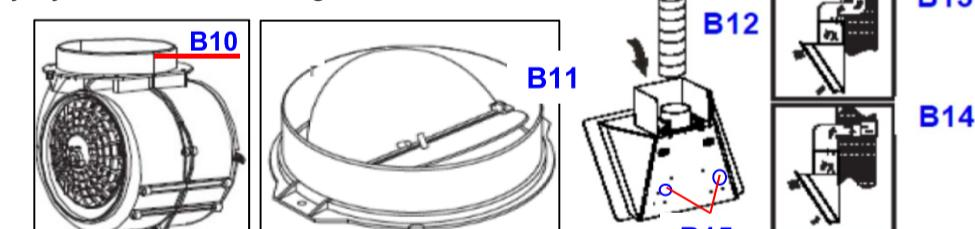
4. Die Haube an der Halterung B3 aufhängen und Haube durch die 2 Löcher in der Rückwand B15 festschrauben, damit die Haube nicht versehentlich aushängen kann.
