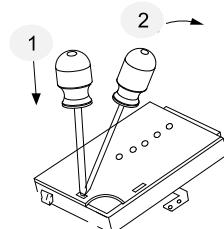
Das grün-gelbe Kabel an die mit Erdungszeichen gekennzeichnete Klemme anschließen.
