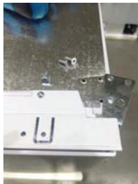
Schritt 1: Entfernen Sie die oberen Scharnierbefestigungsschrauben und legen Sie sie beiseite.
