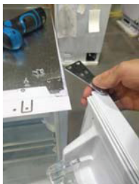
Schritt 2: Legen Sie die geschäumte Tür beiseite und entfernen Sie die Tür
