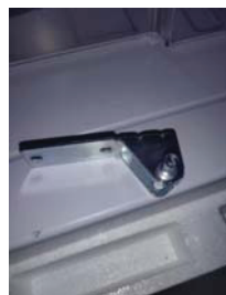
Schritt 5: Entfernen Sie das untere Scharnier
