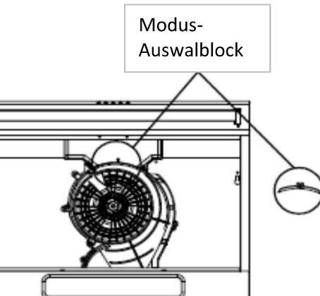
Dann montieren Sie den Kohlefilter, indem Sie ihn an die Filteraufnahme unten am Motor führen und durch Rechtsdrehung fest montieren. (Bajonettverschluss)
