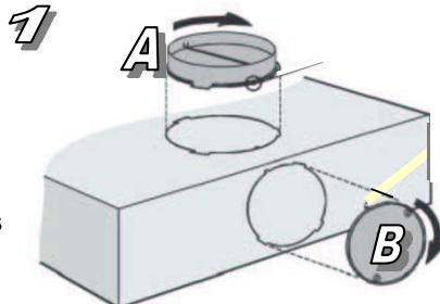
**Abb. 2** (nicht für alle Modelle zutreffend) zeigt die verschiedenen Varianten für Kernbohrungen und die dabei zu beachtenden Masse in mm.
