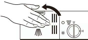
**3** Schließen Sie die Abdeckung und drücken Sie darauf, bis sie einrastet.
