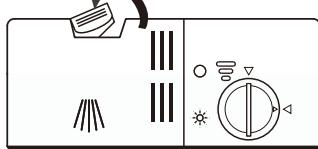
**1** Drücken Sie die Entriegelung am Spülmittelbehälter, um die Abdeckung zu öffnen.
