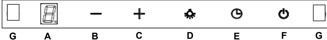
1. Nach dem Anschließen der Dunstabzugshaube an die Steckdose wird die Hintergrundbeleuchtung aller Tasten eingeschaltet. Die LED-Anzeige "A" leuchtet nicht. Die Dunstabzugshaube hat keine Funktion und ist im Standby-Modus. Die Hintergrundbeleuchtung aller Tasten wird nach 2 Sekunden ohne Bedienung automatisch ausgeschaltet.
