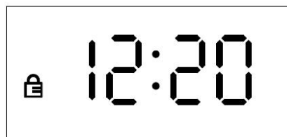
Bild 10: Anzeige bei aufgehobener Türverriegelung
