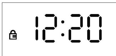
Bild 10: Anzeige bei aufgehobener Türverriegelung
