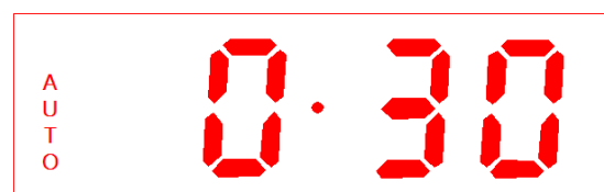
Abb. 25: Anfangsanzeige der Garzeitprogrammierung
