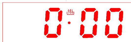
Abb. 7: Auswahlmodus (zweites Symbol leuchtet)
