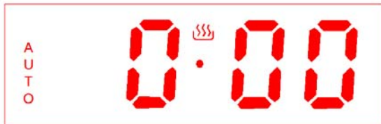
Abb. 18: Ausschalten des Automatiksymbols (wenn Gardauer abgelaufen)
