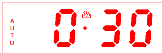
Abb. 30: Ausschalten des Automatiksymbols (wenn Garzeitende erreicht)
