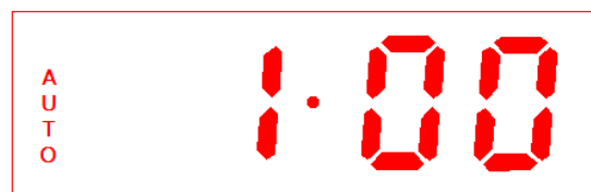
Abb. 30: Ausschalten des Automatiksymbols (wenn Garzeitende erreicht)
