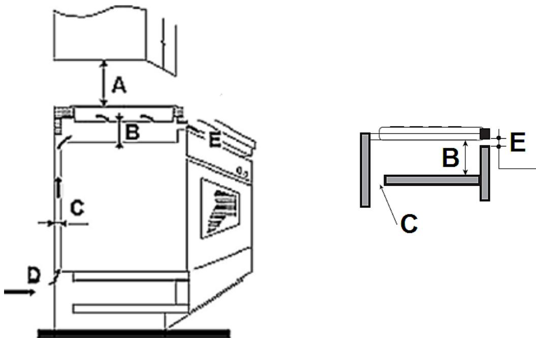
**C = BELÜFTUNGSSCHLITZ / E = LUFTAUSLASS**
