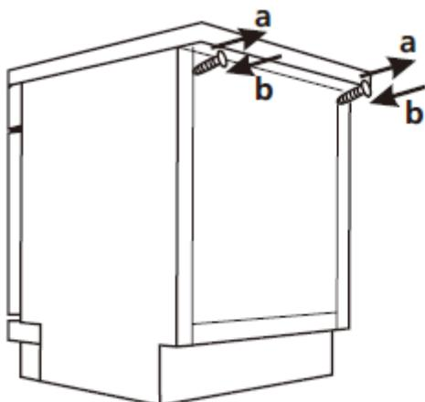
**HINWEIS!** Nach dem Abnehmen der Arbeitsplatte müssen die Schrauben wieder unter die Hinterkante der Platte geschraubt werden (b).
