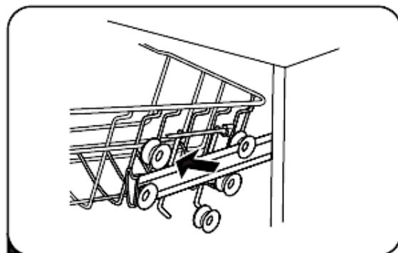
4. Setzen Sie den Geschirrkorb (A) wieder ein und positionieren Sie die Führungsschienen (B) zwischen dem mittleren (D) und den unteren Radsätzen.
