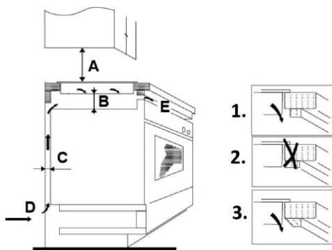
**D = BELÜFTUNGSSCHLITZ / E = LUFTAUSLASS**
