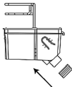
4. Bringen Sie den O-Dichtring an der Unterseite des Wassertanks an. Achten Sie darauf, dass dabei keine Falten und Knicke entstehen.
