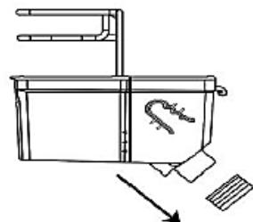
3. Reinigen Sie alle Teile (Wassertank, Abdeckung, O-Dichtring und Wasserventil mit warmem Seifenwasser. Spülen Sie dann alles mit klarem Wasser gut ab und trocknen Sie alle Teile.
