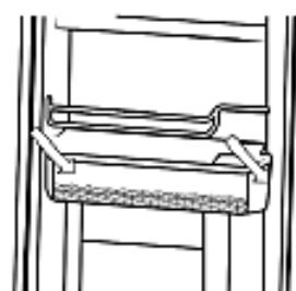
5. Bringen Sie den Wassertank wieder in der Tür an. Achten sie beim Einbau darauf, dass der O-Dichtring vorher in das Wasserventil eingebracht wurde. Halten Sie dann beide Seiten des Wassertanks gut fest, richten Sie die Steckplätze am Wassertank an denen in der Tür aus und bringen Sie den Wassertank in einem 45° Winkel.
