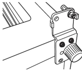
6. Versetzen Sie den Scharnierstift (1) an Position 2. Bringen Sie das Scharnier auf der gegenüberliegenden Seite an. Schrauben Sie den Fuß ein.
