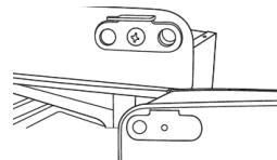
5. Kippen Sie das Gerät **maximal um 45°** nach hinten, um Zugang zum unteren Scharnier und den Füßen zu erlangen. Entfernen Sie die Füße und Schrauben, die die rechte Scharnierplatte halten, und die Befestigungsplatte.
