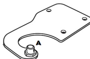
4. Entfernen Sie die Scharnieraufnahme unten an der Tür und bringen Sie diese an der gegenüberliegenden Seite an.
