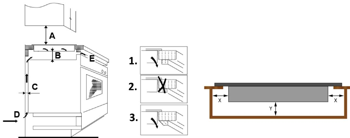
**D = BELÜFTUNGSSCHLITZ / E = LUFTAUSLASS**
