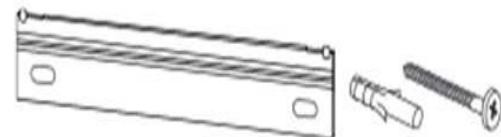
Die Hängeschränke können bei korrekter Montage mit ca. 40 kg belastet werden. Achten Sie auf eine gleichmäßige Lastverteilung
